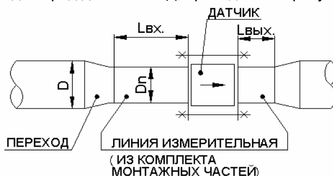
Рисунок 1 Установка датчика МД в трубопровод большего D_y
