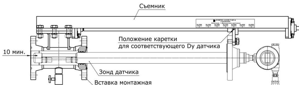
Рисунок 4 – Установка положения зонда датчика
