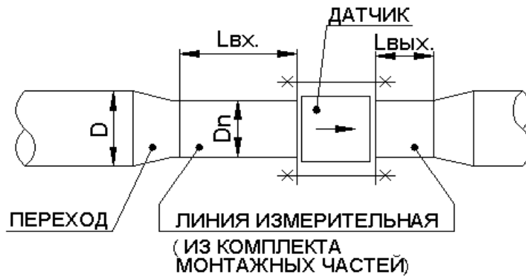
Рисунок 1 Установка датчика в трубопровод большего D_y
