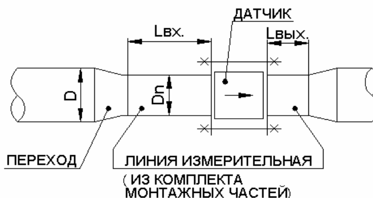
Рисунок 1 Установка датчика в трубопровод большего D_y
